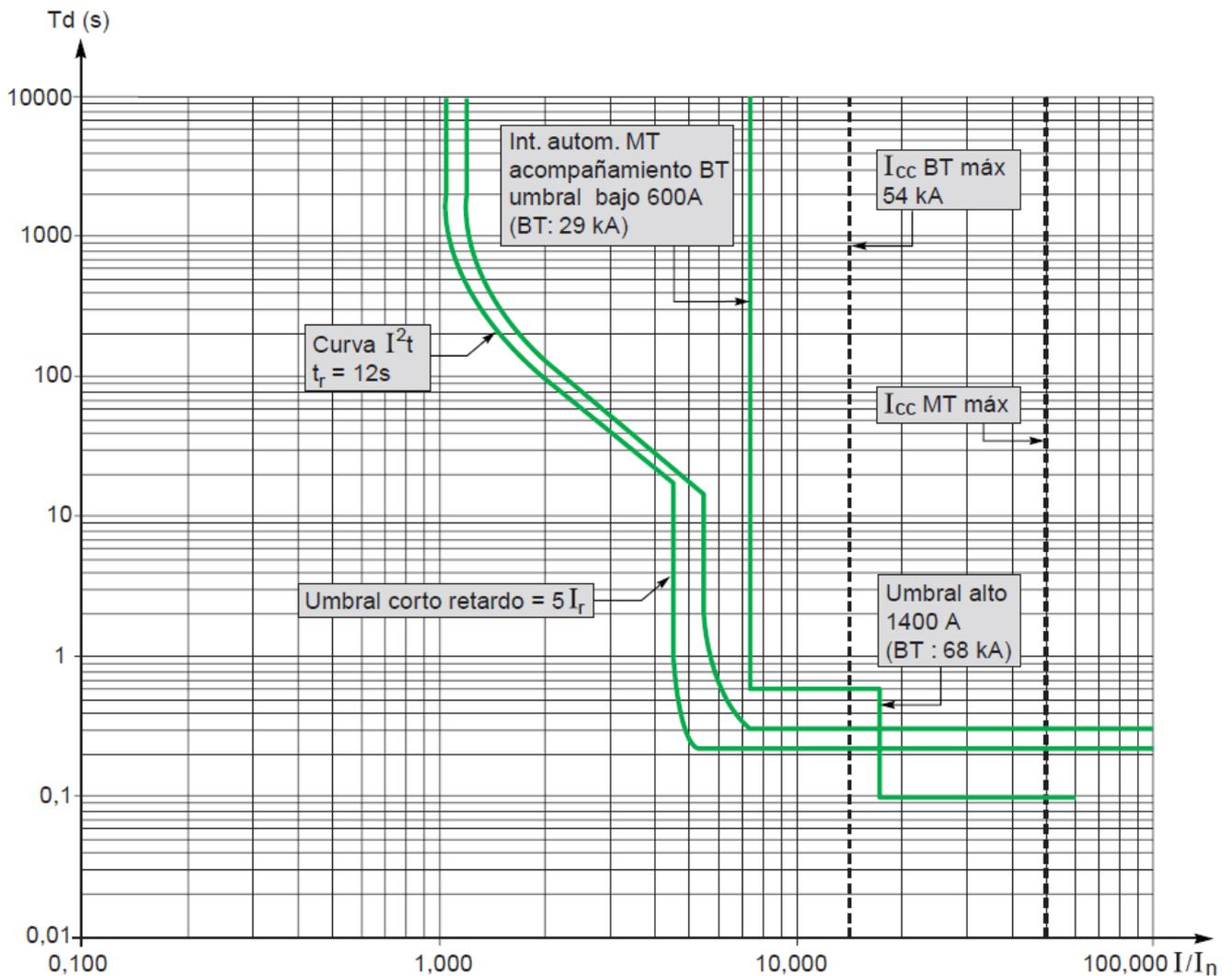
El primero sirve de protección en caso de cortocircuito entre el transformador y el interruptor automático BT, o en caso de fallo de la protección BT. El segundo sirve de protección en caso de cortocircuito por encima del transformador.
