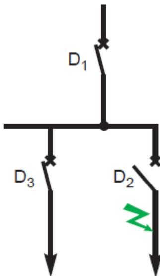
Permite también aunar seguridad y continuidad del servicio facilitando la localización de los defectos. Es un concepto especialmente importante para los aparatos de gran potencia y, puesto que están instalados en cabeza de la instalación, su disparo injustificado tiene consecuencias muy graves.
