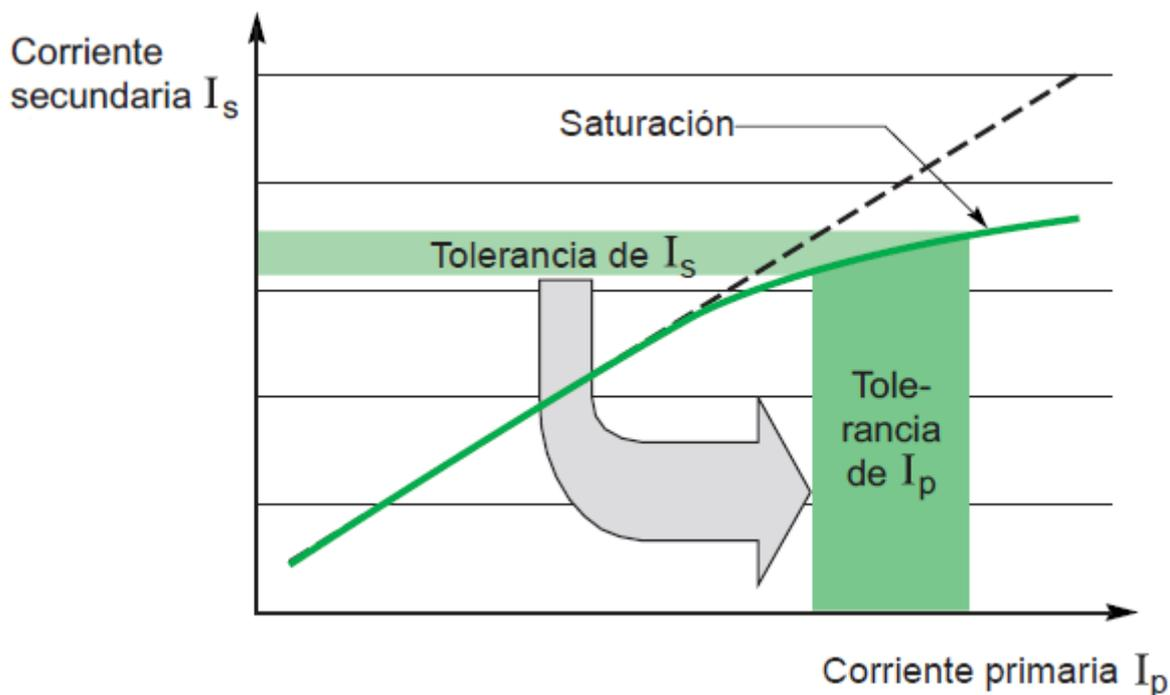
Además, al cerrarse un interruptor automático sobre un cortocircuito, la respuesta del captador a la primera onda de corriente está estrechamente ligada al estado magnético (magnetismo remanente) en el que le ha dejado la corriente anterior. Si al cerrar, la corriente primaria es del mismo sentido que la anterior, la corriente secundaria  $I_s$  quedará muy atenuada en la primera onda; pero si es de sentido inverso,  $I_s$  quedará aumentada.
