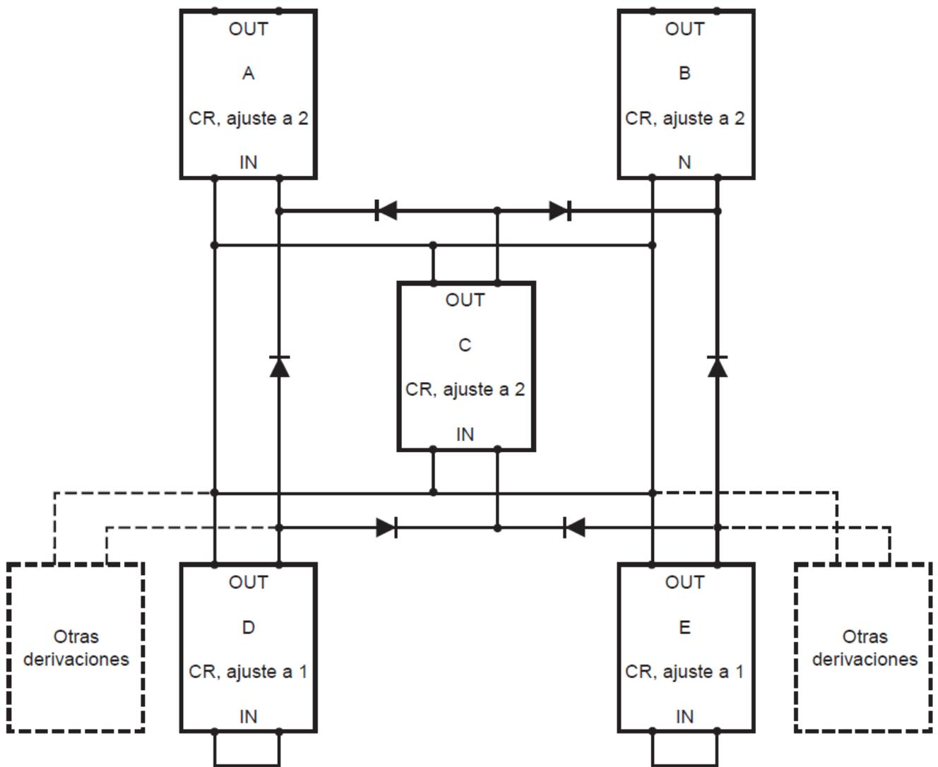
Cuando un relé detecta un defecto superior a su umbral de corto retardo, cortocircuita los bornes de salida. Cuando un relé ve sus bornes de entrada cortocircuitados, activa la temporización de corto retardo. Si no, dispara instantáneamente
