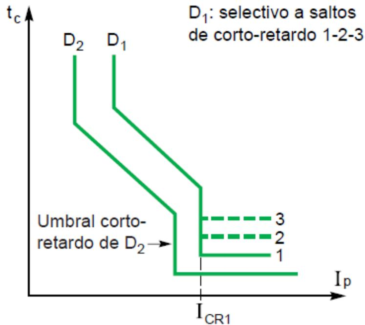
Esta solución no puede adaptarse si no es con la condición de que el aparato pueda soportar la corriente de cortocircuito durante el tiempo de la temporización. Por tanto, solamente puede utilizarse con los aparatos de gran resistencia electrodinámica, llamados también «selectivos».
