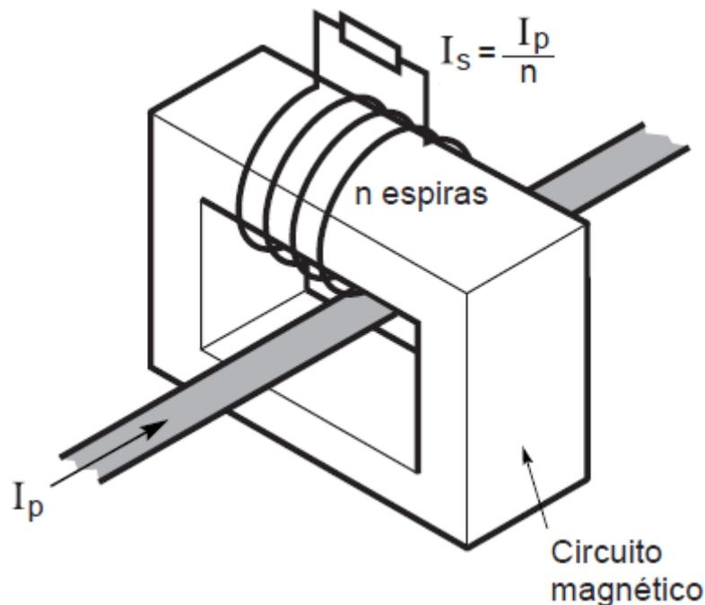
Esta tecnología, la más antigua, ofrece una precisión satisfactoria en el caso de aparatos que tienen un valor bajo de TED. Estos transformadores tienen un arrollamiento secundario de  $n$  espiras alrededor de un núcleo de material magnético, estando el primario formado por el paso a través del circuito magnético de un conductor principal.
