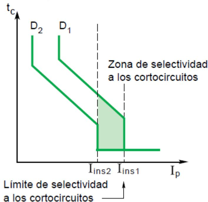
La selectividad queda asegurada si el umbral máximo del relé del aparato aguas abajo es inferior al umbral mínimo del aparato aguas arriba, incluidas todas las tolerancias.
