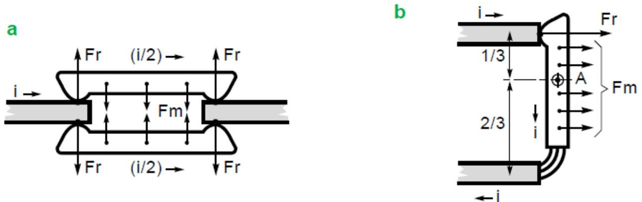
– las pinzas están constituidas por dedos situados a cada lado de los conductores a unir; por estos dedos circulan corrientes paralelas que crean un esfuerzo de atracción,  $F_m$ , que compensa los esfuerzos de repulsión,  $F_r$ , producidos en los contactos (figura 9a);
