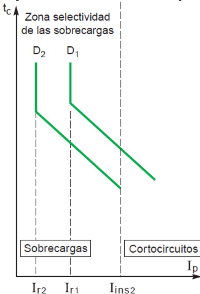
Esta selectividad queda asegurada si, para cualquier valor de la corriente de sobrecarga, el tiempo de no disparo del interruptor aguas arriba, D1, es superior al tiempo máximo de corte del interruptor automático D2 (incluido el tiempo de extinción del arco). Esta condición se cumple en la práctica si la razón  $I_{r1}/I_{r2}$  es mayor que 1,6.
